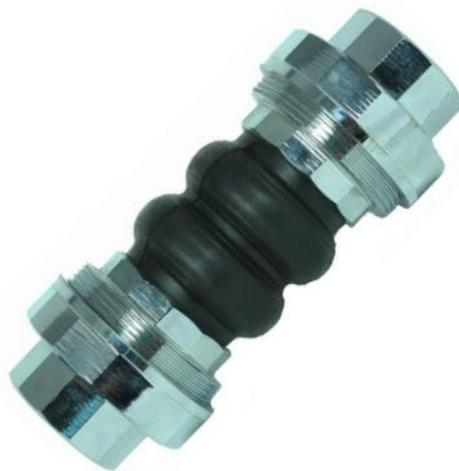
Резиновые компенсаторы предназначены для снижения вибраций, гидравлических ударов, шумов, а также компенсации смещений, тепловых удлинений трубопроводов. Компенсаторы состоят из сальфона, который является основным компенсирующим элементом, и соединительных стальных фланцев или резьбовых муфт для крепления к трубопроводу.
